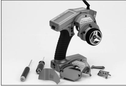
Die DX3R PRO ist im Auslieferungszustand für Rechtshänder konfiguriert, kann aber sehr leicht für Linkshänder umgebaut werden. Alle für den Umbau erforderlichen Teile sind im Set enthalten. Ein 3/32 Inbus und ein kleiner Kreuzschlitzschraubenzieher werden benötigt.
