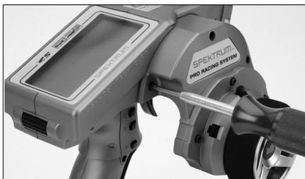
3. Entfernen Sie die drei Inbusschrauben auf der Vorderseite des Gehäuses (siehe Abbildung).
