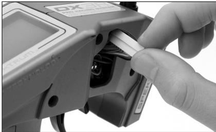
10. Schieben Sie die Steckleiste für den Steuerradstecker durch das Gehäuse auf die andere Seite.
