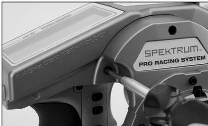
2. Schrauben Sie mit dem 3/32 Imbusschlüssel die drei Schrauben an der Gehäusefront los.
