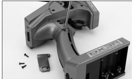
5. Entfernen Sie vorsichtig die Kreuzschlitzschrauben, die die beiden Griffplatten halten (zwei pro Seite) und entfernen Sie die Griffplatte ohne Schalter.
