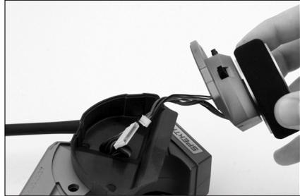
5. Setzen Sie den gewünschte ( Links / Rechts ) Adapter auf und führen die Lenkrad Verbindung durch die Öffnung.
