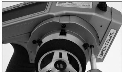
7. Setzen Sie die Abdeckung auf und schrauben die drei Schrauben fest.
