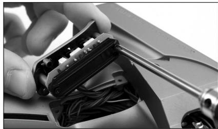
6. Ziehen Sie nun vorsichtig die Griffplatte heraus, die die Schalter D, E und F enthält. Entfernen Sie nun die Platine mit dem Schraubenzieher von der Griffplatte und merken Sie sich die Anordnung der Schalter.
