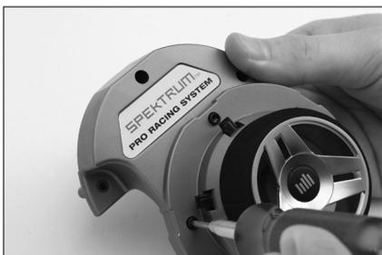
4. Schrauben Sie mit dem 3/32 Imbusschlüssel die drei Schrauben vorne am Dropdown Lenkrad ab.
