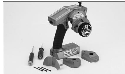
Die DX3R PRO wird mit einem Dropdown Lenkrad geliefert und kann auf ein Standard Lenkrad umgebaut werden. Alle zum Umbau benötigten Teile sind im Lieferumfang enthalten. Sie brauchen hierzu den im Lieferumfang enthaltenen 3/32 Imbusschlüssel und einen kleinen Kreuzschlitzschraubendreher.
