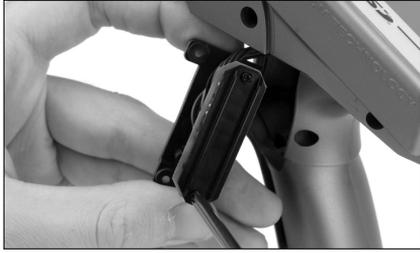
8. Schrauben Sie die Leiterplatte und die Rückenplatte fest und testen Sie, dass sich alle Schalter einwandfrei drücken lassen.
