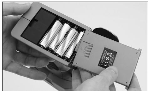
Öffnen Sie den Batteriefachdeckel am Boden der Anlage. Legen Sie die Batterien in die Einzelfächer ein. Achten Sie auf die korrekte Polarität. Sie ist auf dem Boden jedes Einzelfachs angezeichnet.
