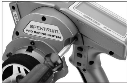
13. Schrauben Sie das Steuerrad nun mit den Inbusschrauben am Gehäuse fest.
